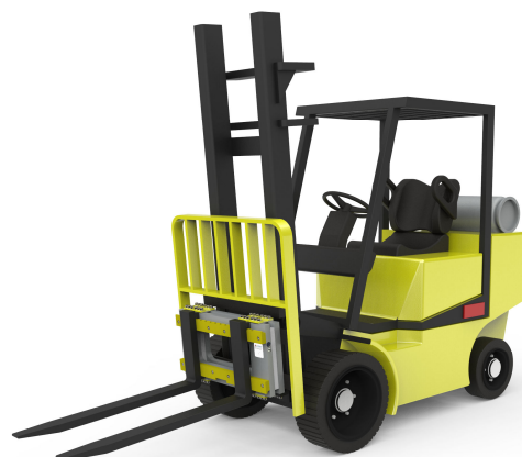
EP5500 montado na empilhadeira
